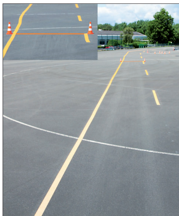
Bild 19: Zielbremsung mit 45 m langer Strecke und 3,30 m breiter Haltlinie.
